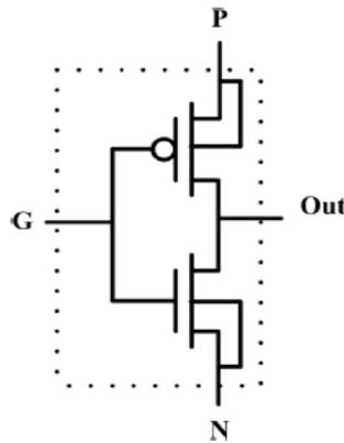
Fig. 1 Basic Gate-Diffusion Input (GDI) cell
