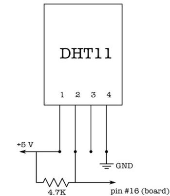
Fig. 3 DHT11 Pin Configuration
