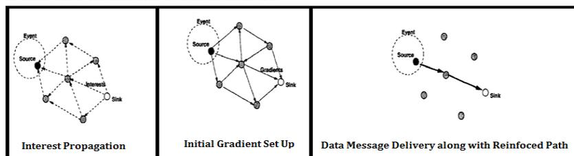
Fig. 3 Direct Diffusion Routing Protocol
