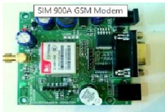
Fig5. GSM MODULE SIM900
