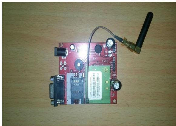
Fig. 4 GSM SIM 300
