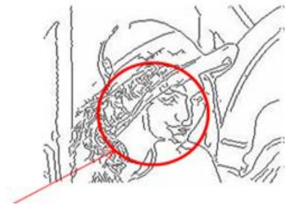
(b) Edge detection using Canny edge detector
