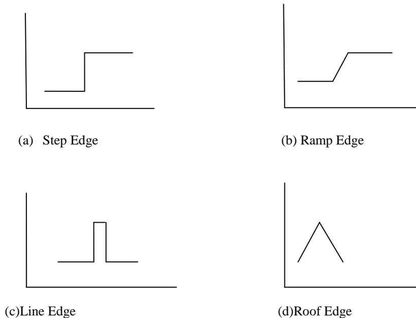
Fig.1. Type of Edges (a) Step Edge (b) Ramp Edge (c) Line Edge (d) Roof Edge
