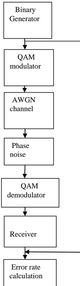
Fig. a. Basic QAM Simulink Model
