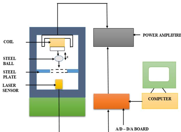
Fig1. Magnetic Levitation Model<sup>[19]</sup>
