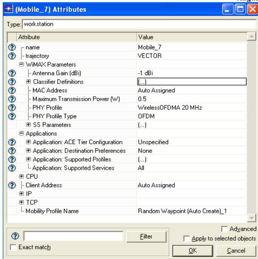
Figure-2 Node parameters
