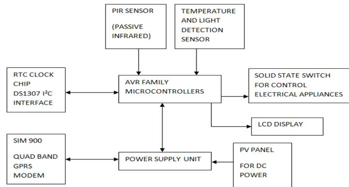
Fig:Block diagram-Automation System
