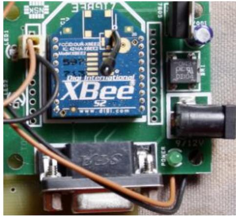
Fig. 4 Zigbee Module
