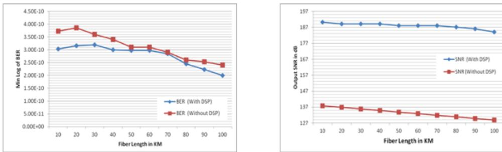
(d) BER vs Fiber Length (e) SNR vs Fiber Length
