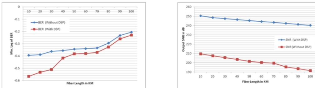
(d) BER vs Fiber Length (e) SNR vs Fiber Length
